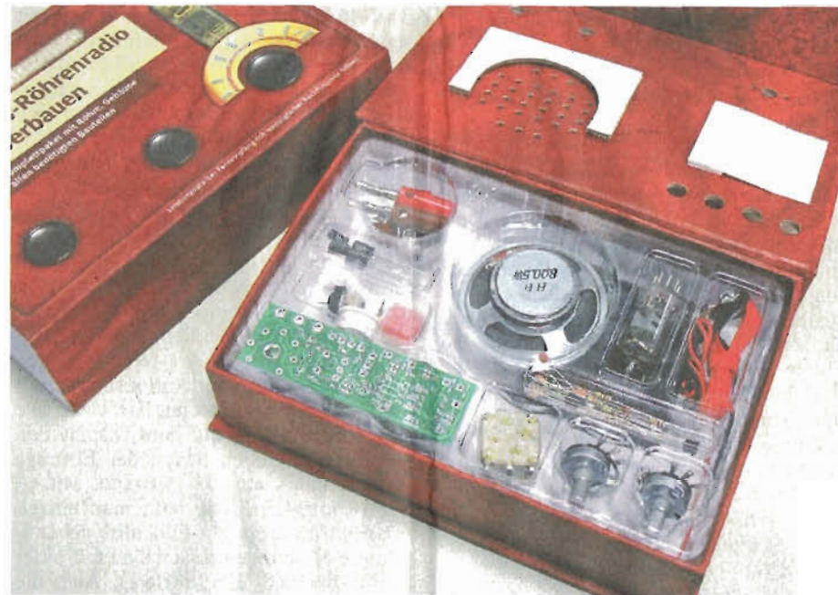
Eigenbau: Die Schachtel wird zum Radio-Gehäuse, links die winzige Platine Fotos Pardey
